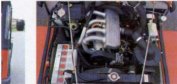
■ Das ist er, der neue Mahindra-Motor. Der 1,9-Liter-Peugeot-Diesel kommt aus Frankreich nach Indien
